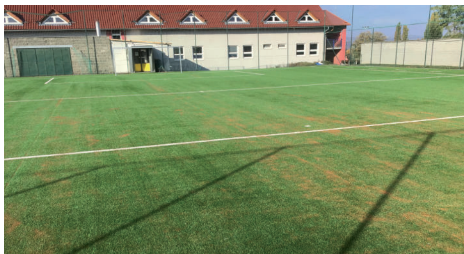
Starež korek - také tréninkové hřiště v Brně Ivanovicích, kde jako výplň (infill) je použit korkový zásyp
